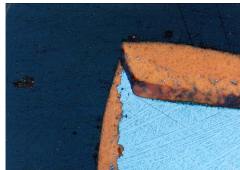
Grate u. scharfe Kanten
